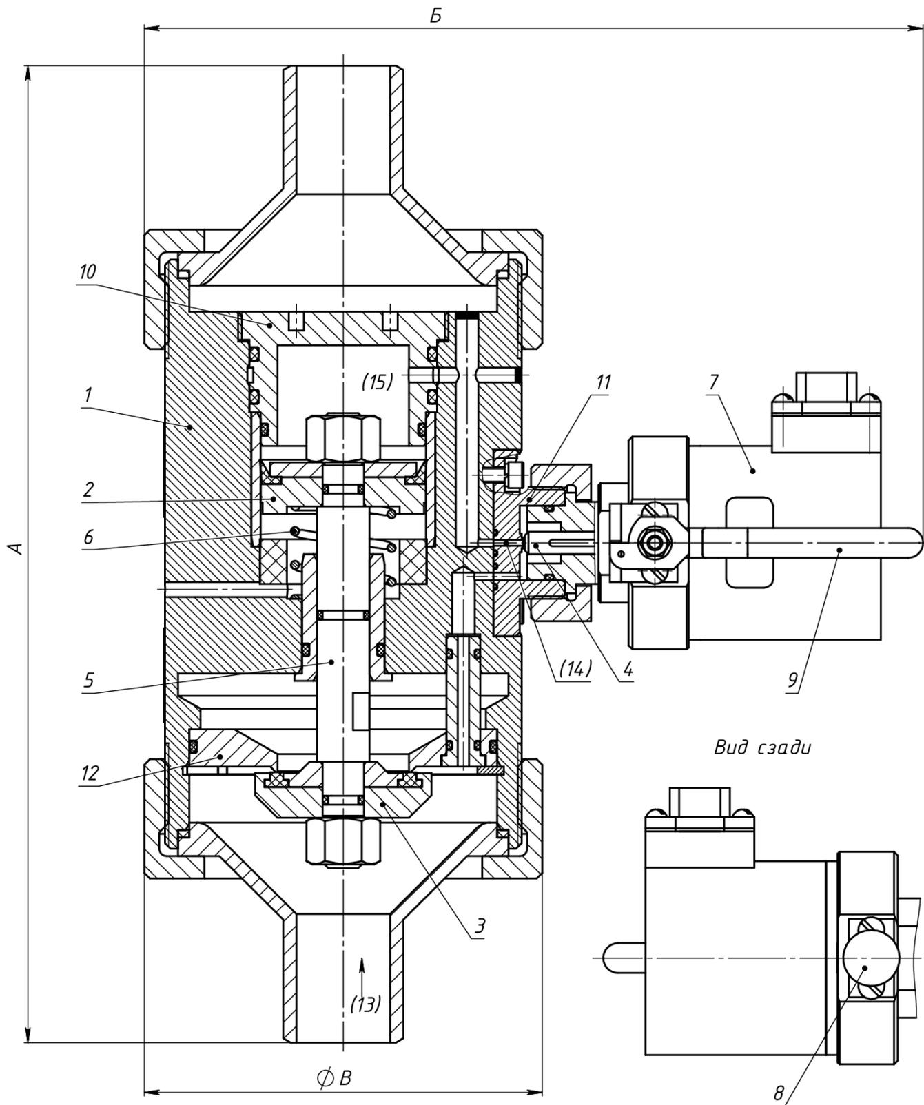
Рис. А.1 Конструкция распределительного устройства типа РУ-025-150-П(-В3), РУ-032-150-П(-В3), РУ-050-150-П(-В3), РУ-065-150-П(-В3), РУ-080-150-П(-В3), РУ-100-150-П(-В3).
