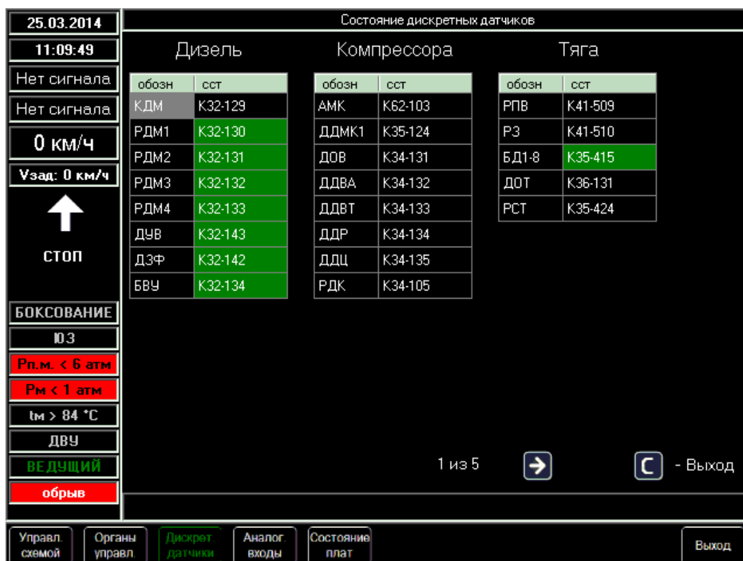
Рисунок 44 - Кадр ДИСКРЕТНЫЕ ДАТЧИКИ
