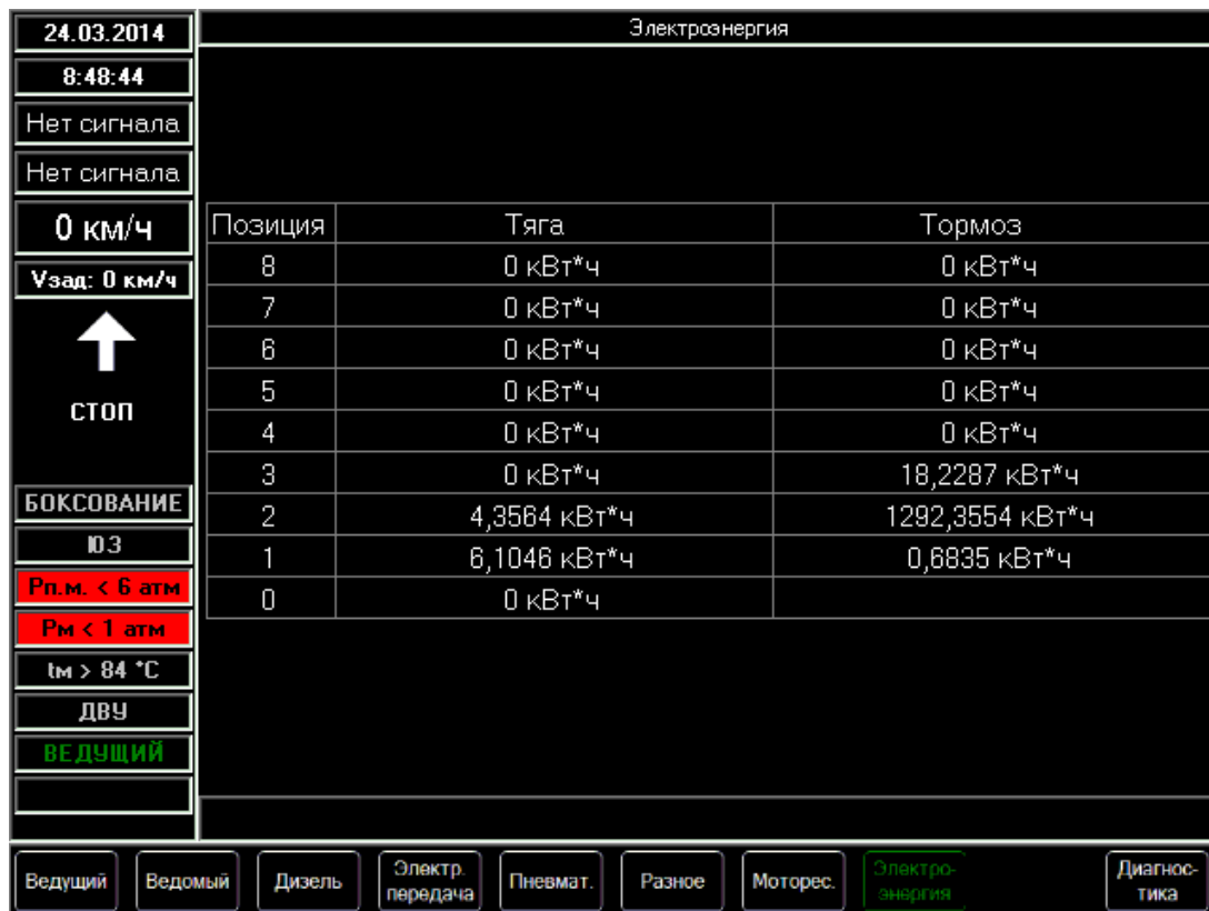
Рисунок 10 - Кадр ЭЛЕКТРОЭНЕРГИЯ ведущей секции
