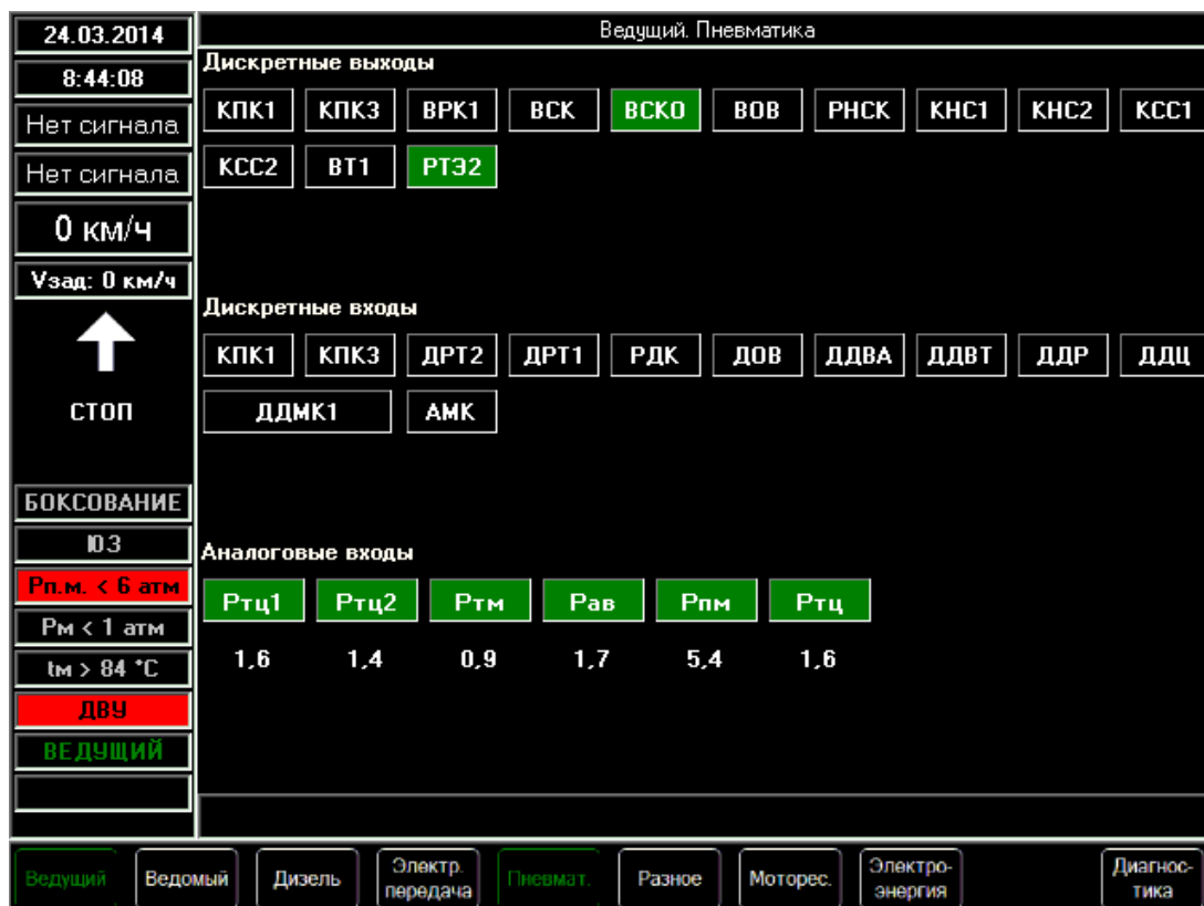
Рисунок 7 - Кадр ПНЕВМАТИКА ведущей секции
